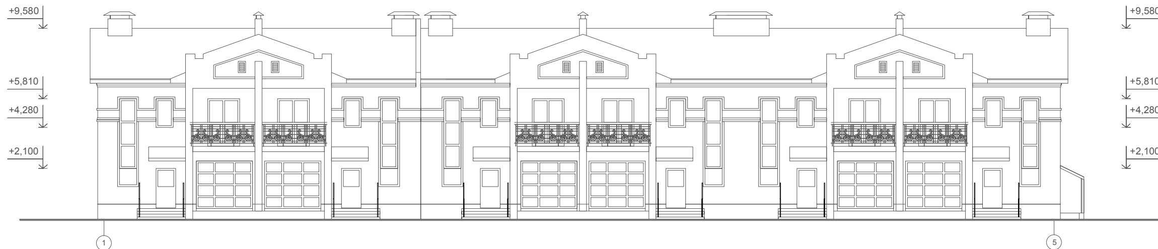
Фасад в осях 1-5
